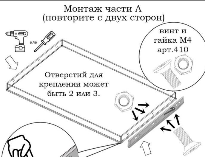
винт и гайка М4 арт.410
